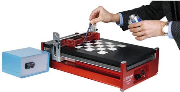
Il sistema fornito dall'azienda Zehntner permette la deposizione di strati a spessore controllato di materiali aventi diverse viscosità. L'applicatore automatico di film permette una stesura uniforme, accurata e riproducibile di vernici, inchiostri e sostanze adesive su substrati di vario tipo. Lo ZAA 2300 consente di impostare la velocità di stesura ottimale a seconda della viscosità del materiale. Il piatto per vuoto ZE
